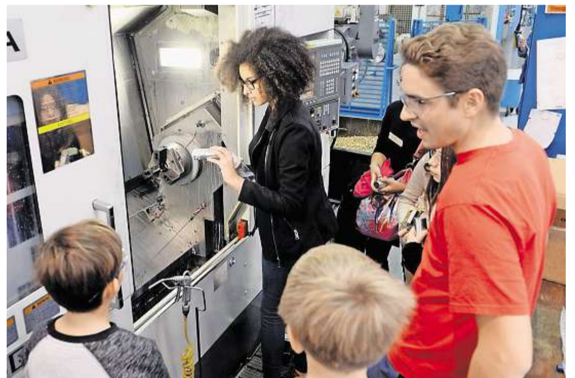
Die zwölfjährige Amanda kontrolliert das Werkstück, in das die Maschine ein Gewinde geschnitten hat. hd
